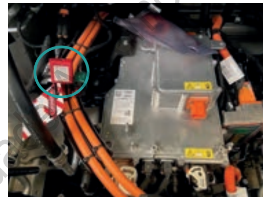
Exemplo de travamento com cadeado
